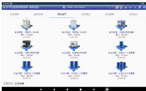
容器设置：平板 App 支持『叉板、牛皮纸袋、布袋、吨桶、塑料桶、金属桶、复合材料』多种容器、供做称重时去皮选择。
